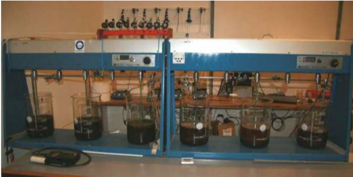
Figur 9-3 Hydrolyseforsøg (batchforsøg) på slam fra Løgstrup (Ref. 5, Janning)
