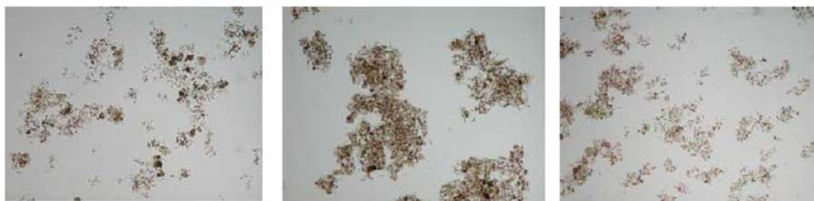
Figur 6-2 Aktiv slam fra tre renselanlæg med partikelstørrelser mellem 50 og 300 µm
