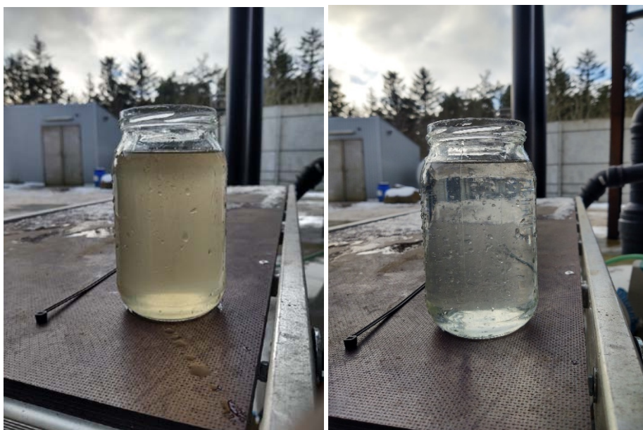
Figur 11-10 Foto af vand udtaget før og efter ozon- og proteinskimmer anlægget. (Foto Clement Crouzet)
